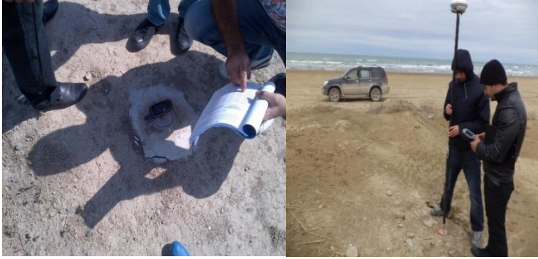
Şəkil 4-5. Torpaq reperlərindən ibarət sıxlaşdırılmış geodeziya şəbəkə məntəqələri.
