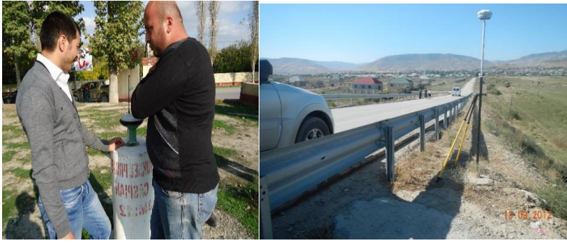
Şəkil 2-3. Geodeziya istinad (başlangıç) məntəqələri.
